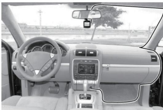
2. 延伸至車門框膠條處 (A柱內側)，向下至腳踏地毯 (墊) 下固定後，接至中控台。
