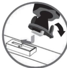
2. 將行車記錄器主機放置於車輛適合位置，先將玻璃保護貼貼上，將支架底座下 3M 貼紙撕開，貼覆於玻璃保護貼，即可固定車架。
