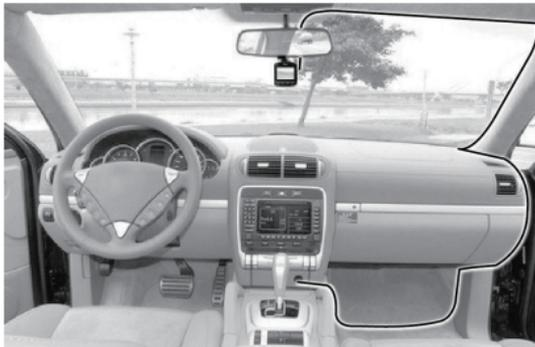
2. 延伸至車門框膠條處 (A柱內側)，向下至腳踏地毯 (墊) 下固定後，接至中控台。
